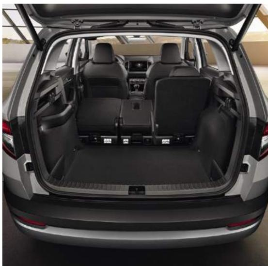
Le système de sièges arrière VarioFlex comprend trois sièges arrière séparés. Vous pouvez rabattre chacun indépendamment ou les retirer totalement. Sièges rabattus, vous disposez d'un espace de 1 605 litres de rangement, qui passe à 1 810 litres une fois qu'ils sont retirés.
