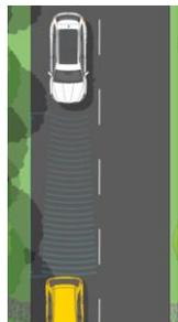
**Régulateur de vitesse Adaptatif** : Maintient une vitesse constante et calcule la distance avec le véhicule qui précède. Si besoin, il décélérera de 3,5m/s. Lié au Front Assist, il alertera le conducteur et décélérera jusqu'à 8 m/s selon les conditions de roulage en cas de danger.
