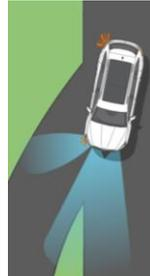
**Corner lights** : Aide à anticiper un obstacle lors d'un virage. En dessous de 40 km/h, antibrouillards avant éteints, la fonction éclairage d'angle s'active. Elle agit à droite ou à gauche selon l'allumage des clignotants et mouvements du volant.
