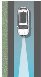
**Assistant de maintien dans la voie (Lane Assist)** : Si votre véhicule s'approche trop du marquage latéral, une correction active de trajectoire s'effectue au niveau de la direction pour éviter tout risque de collision.
